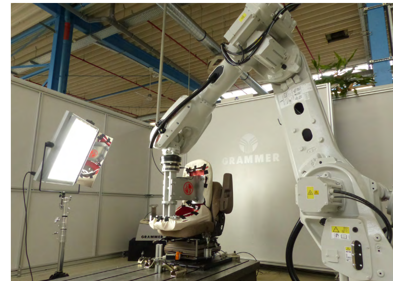
Das neue Roboter-Testsystem im Competence Center in Amberg (D) prüft Sitze auf Herz und Nieren.
